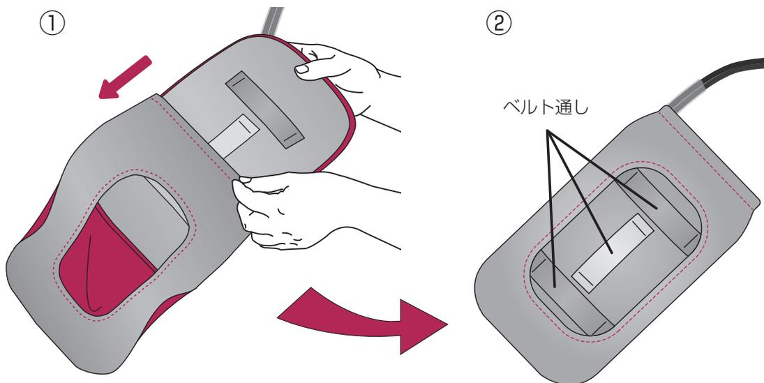
①導子カバーの開いた口から導子を入れます。導子のベルト通しがカバーの穴から見える向きにセットします。
